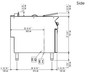
Electrical inlet (power) ΕI Equipotential screw EQ
